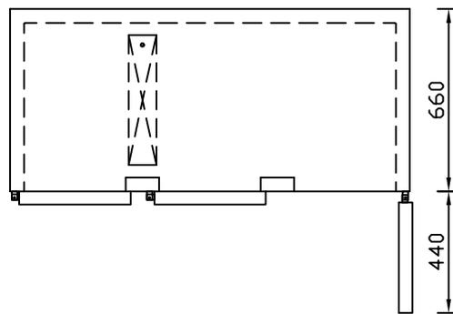
CNS-Verdampfer mit Einspritzventil eingebaut, Kältemittel nach Wunsch
